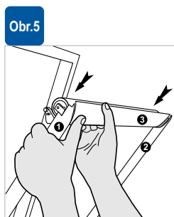
Obr.5 Umístěte roletu do horní části vodících lišt (1+2)
