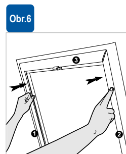
Obr.6 Vsuňte obě vodící lišty s roletou do okenního rámu
